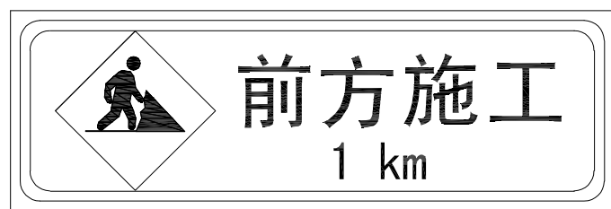
道路施工标志
