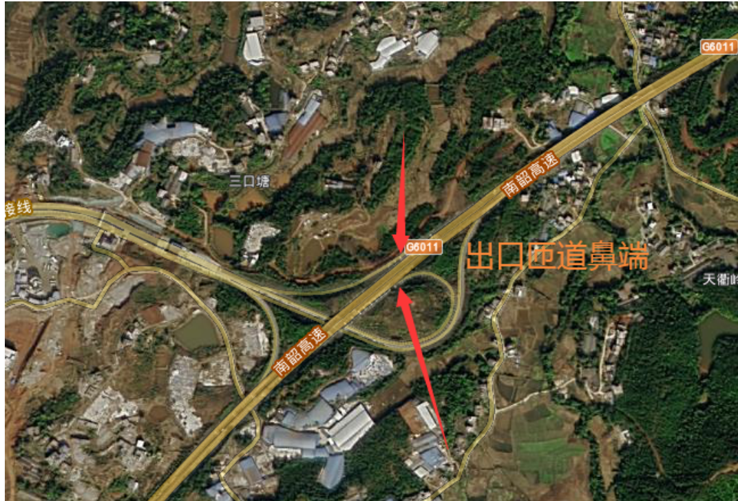
单喇叭出口互通匝道鼻端处设置（单个互通 2 处，全线四个单喇叭互通共 8 处）
